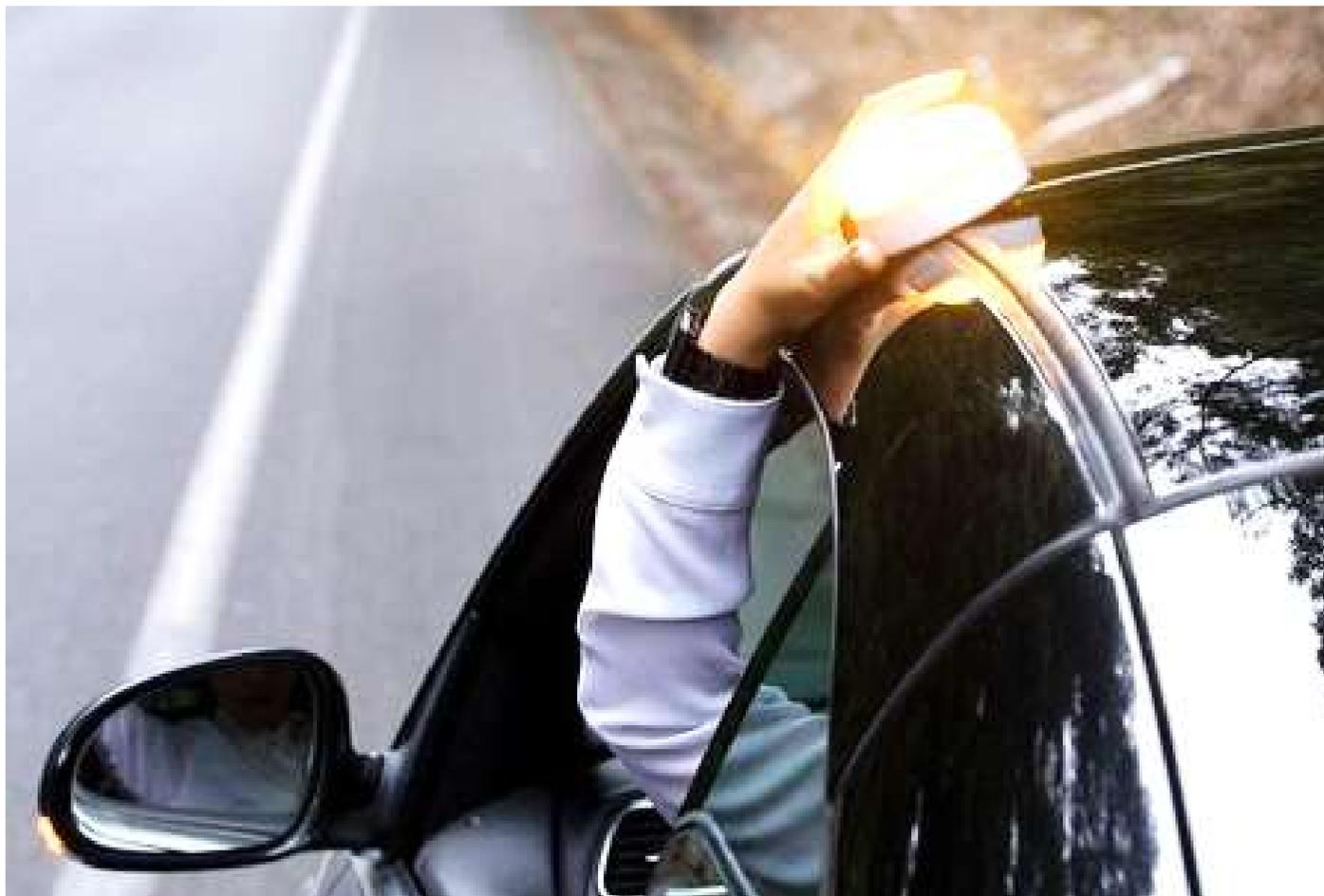
Pero además de evitar que los conductores tengan que caminar sobre la vía en dicha circunstancia, **la nueva señal V-16 estará conectada con Tráfico** mediante una plataforma que permitirá informar al resto de vehículos del punto exacto donde se encuentra activa esta señal.
